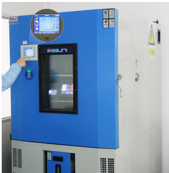
图 6-3 高低温老化测试图
